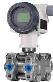
用于液体和气体的高精度压力测量（差压），量程可达 4.0MPa 特别适用于高防爆要求的使用场合（本安型和隔爆型认证），适配隔膜密封技术，可用于高达 400℃ 介质的压力测量多种信号输出：mA/V/HART/MODBUS 多种电气接口：M20、G1/2, NPT1/2, M12 螺纹接口多种过程连接，螺纹连接，法兰连接，以及卫生型连接适用于化工 / 石油 / 能源 / 制药等等过程工业的广泛应用。
