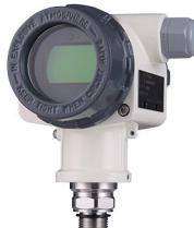
用于液体和气体的高精度压力测量（表压和绝压），量程可达 60MPa，特别适用于高安全性要求的使用场合（本安型和隔爆型认证）。适配隔膜密封技术，可用于高达 400℃ 介质的压力测量，多种信号输出：mA/V/HART/MODBUS 多种电气接口 M20、G1/2, NPT1/2, M12 螺纹接口，适用于化工 / 石油 / 能源 / 制药等等过程工业的广泛应用。通过内置式软件，可用于液位测量。
