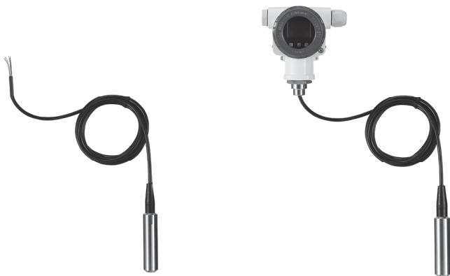
PM10 系列投入式液位计主要由测压元件传感器（也称作压力传感器）、测量电路和过程连接件三部分组成。外部引入的压力或差压将使传感器电容值发生变化，经数字信号转换，变为频率信号送到微处理器。微处理器
